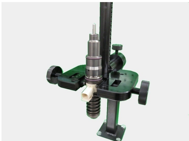
Установка в струбине насос-форсунки VOLVO Delphi 2x и 4x контактные
